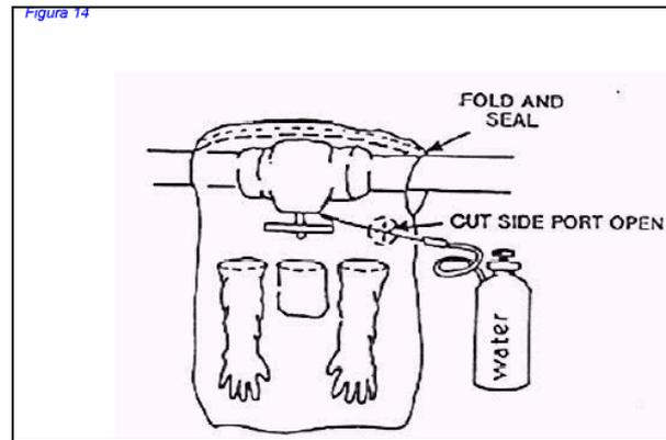
Il glove bag e' una cella di materiale plastico dotata di guanti, si introducono tutti gli attrezzi nel glove- bag e si sigillano le estremita' del glove bag sul tubo, si incapsula il materiale, lo raschia e si pulisce la superficie.
