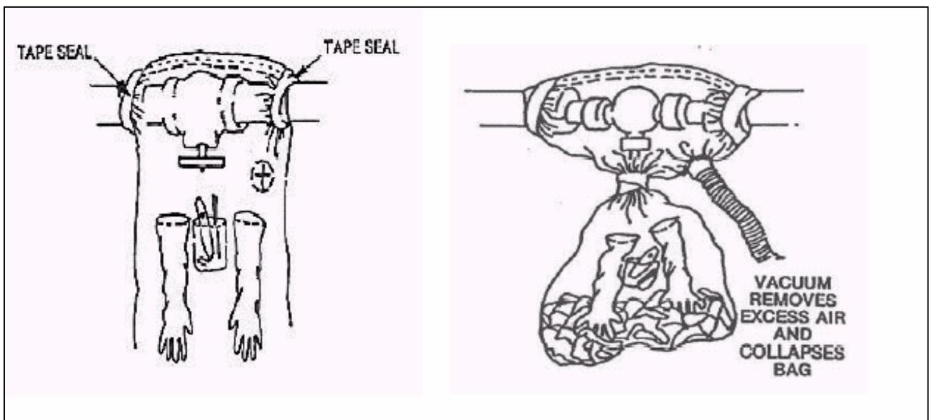
Esempi del procedimento di rimozione amianto friabile con tecnica glove bags
